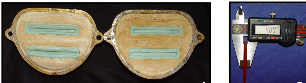
**Figura 2:** Padronização da confecção (A) e medição (B) dos bastões de resina acrílica.
