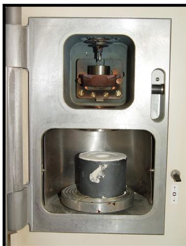
**Figura 10:** Máquina de fundição de titânio (A).
