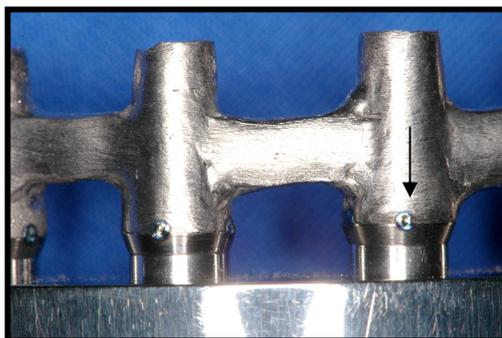
**Figura 16:** Pontos de solda isolados.
