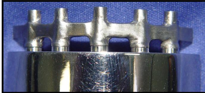
**Figura 13:** Infra-estrutura em monobloco instalada sobre matriz de aço.
