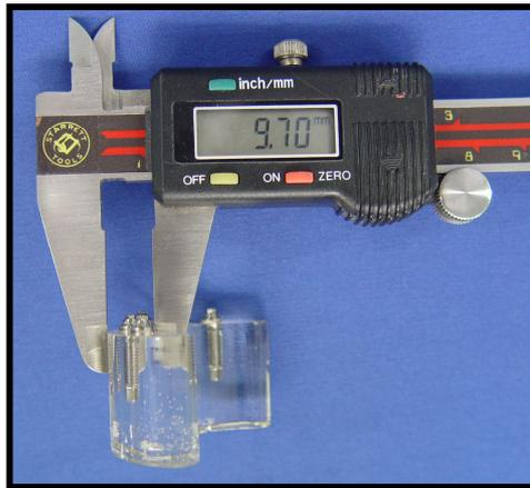
**Figura 41:** Medida da espessura do modelo fotoelástico: 9,7mm.
