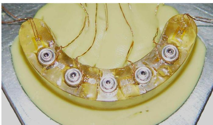
**Figura 47:** Circuito elétrico montado com extensômetros.
