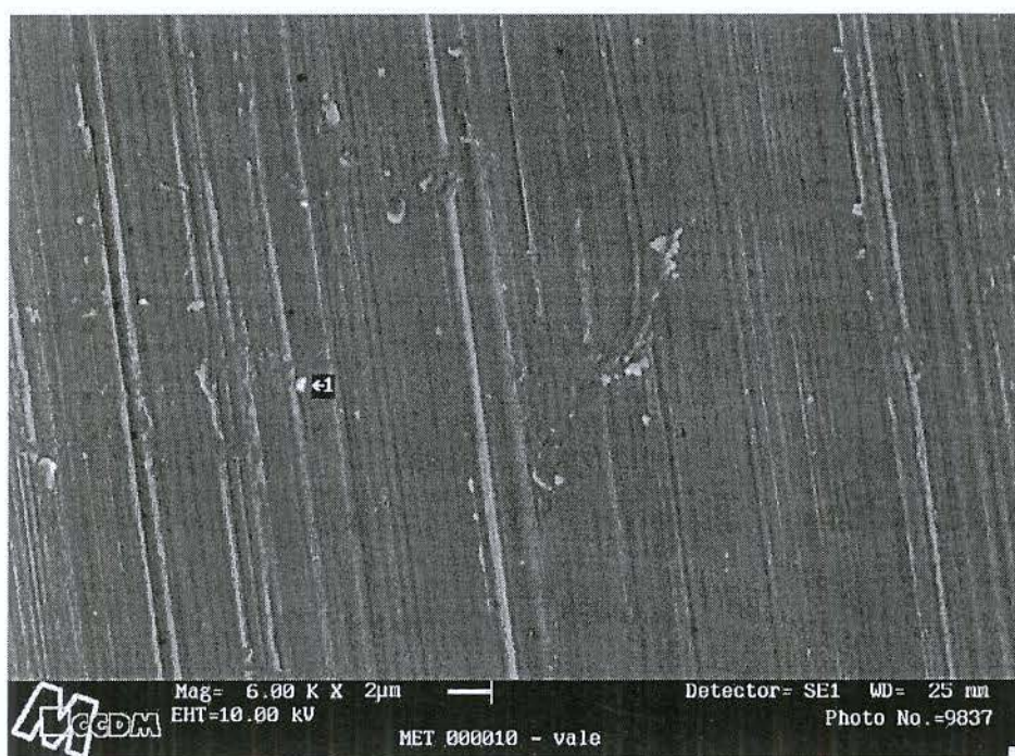
Fig. 25 – MET000010 – Micrografia da superfície (vale) da amostra, apresentando pontos de inclusões (1). 5.000 X – MEV-EDS.
