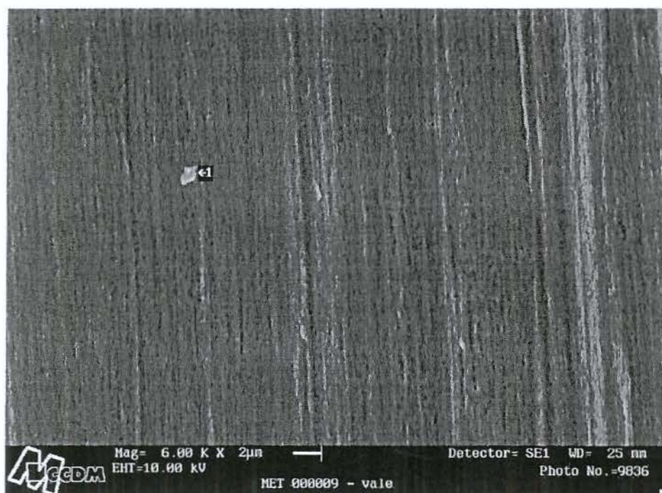
Fig. 21 – MET000009 – Micrografia da superfície (vare) da amostra, apresentando pontos de inclusões (1). 5.000 X – MEV-EDS.
