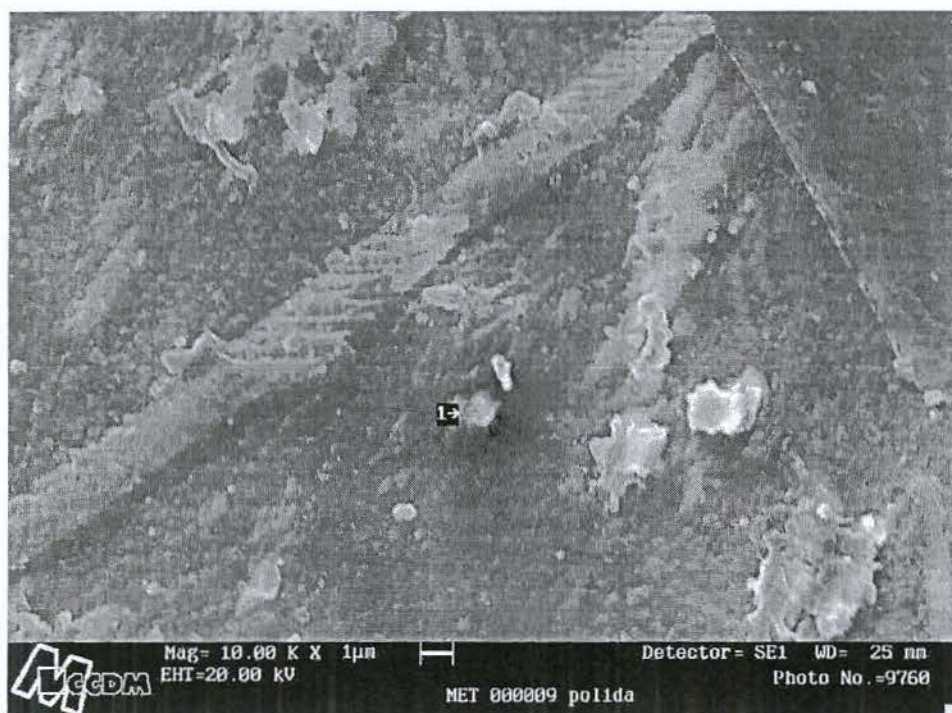
Fig. 35 – MET000009 – Micrografia em corte transversal apresentando pontos de inclusões (1) – MEV-EDS.
