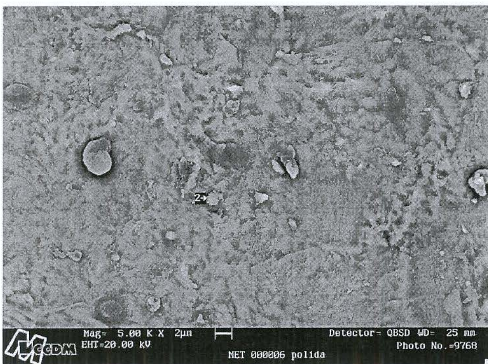
Fig. 33 – MET000006 – Micrografia em corte transversal apresentando pontos de inclusões (2) – MEV-EDS
