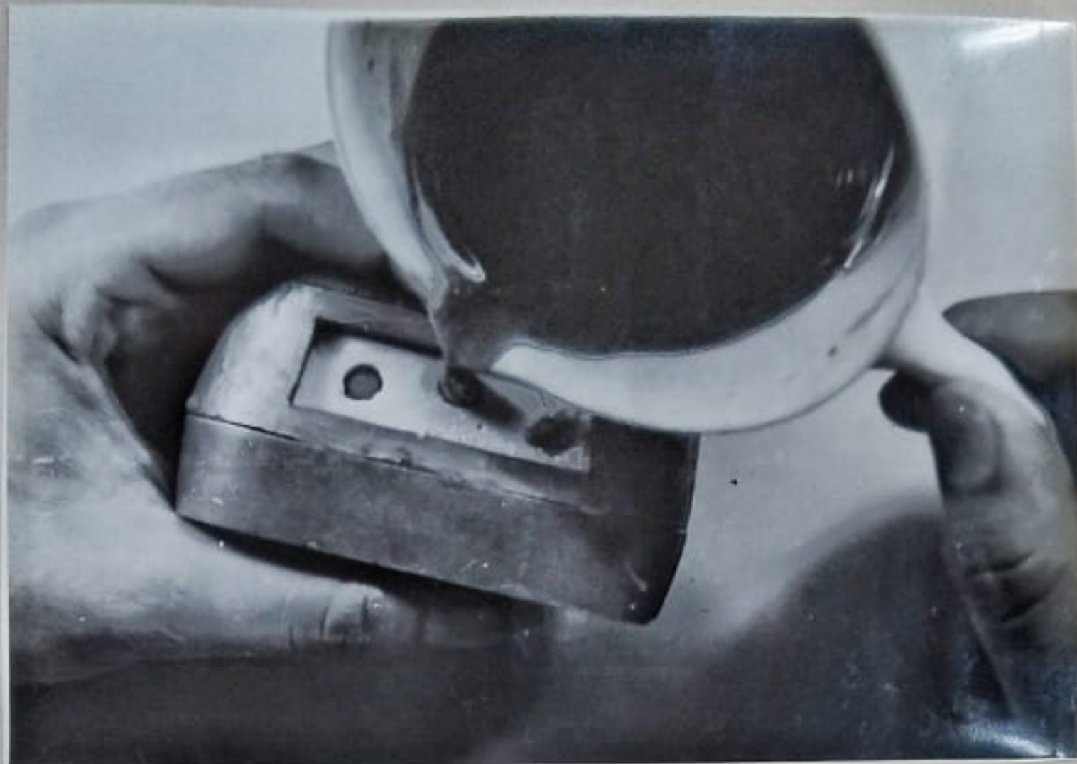
FIG. 21 - Vazamento da cêra para o interior do molde
