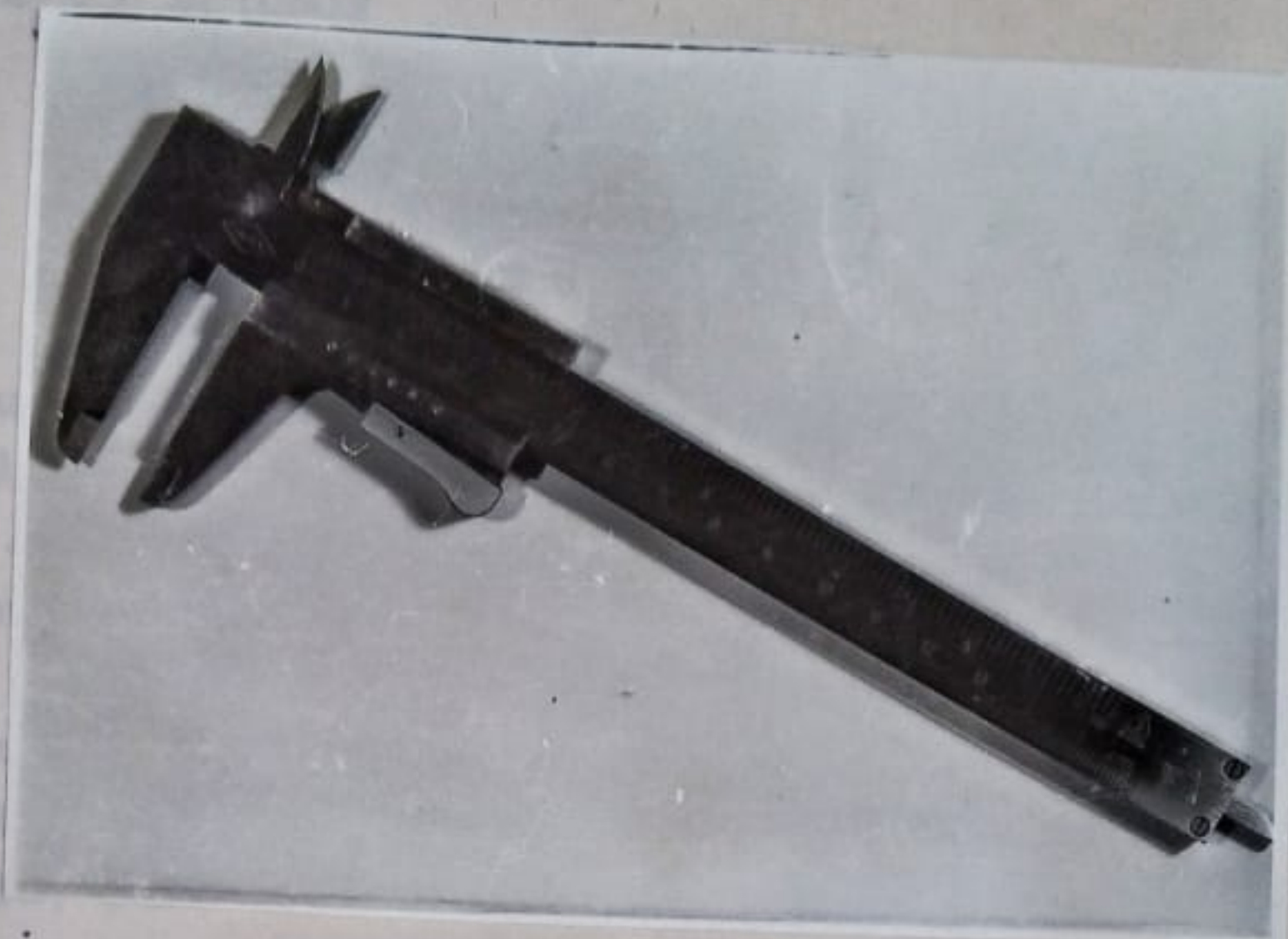
FIG. 5 - Paquímetro "Vernier" utilizado nas mensurações.
