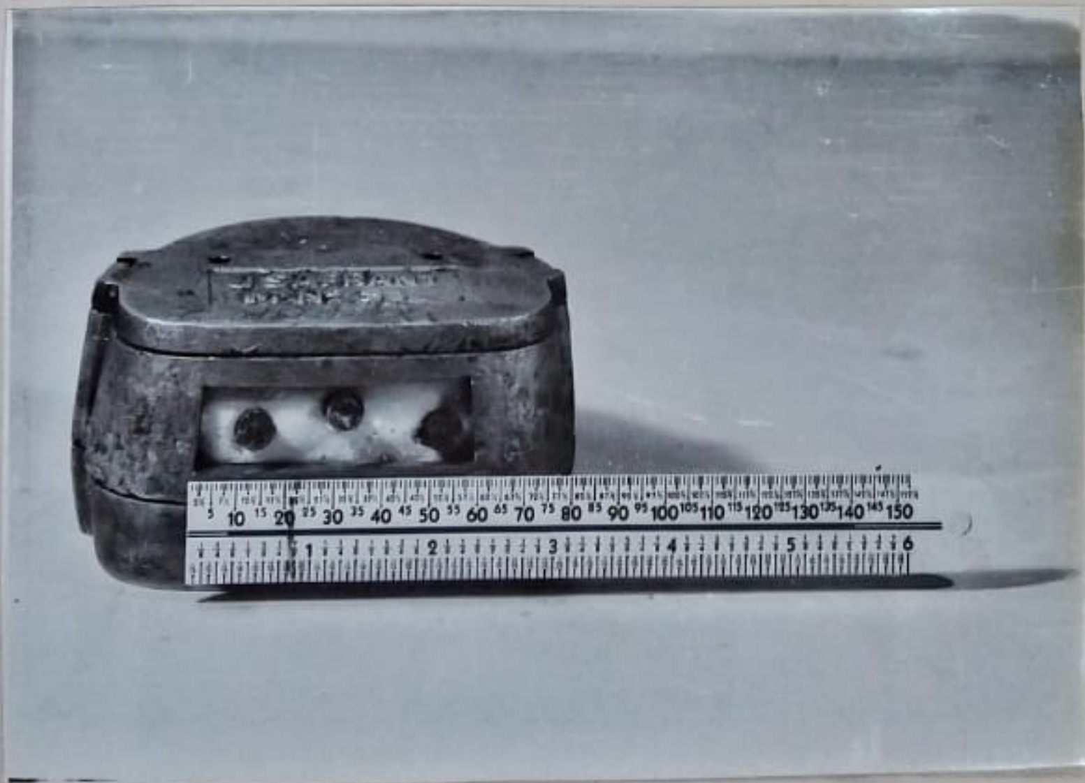
FIG. 22 - Abertura posterior da mufla
