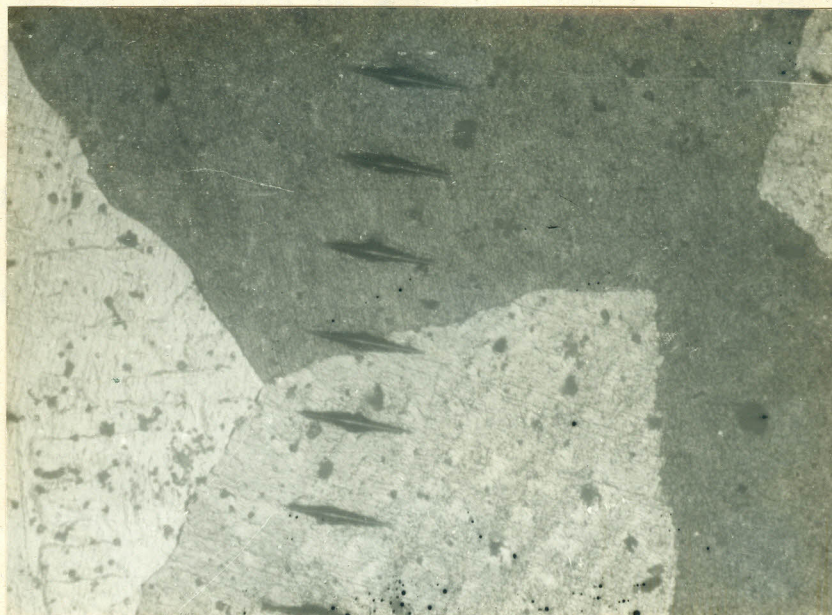
FIG. 16 - Fotomicrografia mostrando marcas de dureza Knoop após tratamento termo-endurecedor - 100 X
