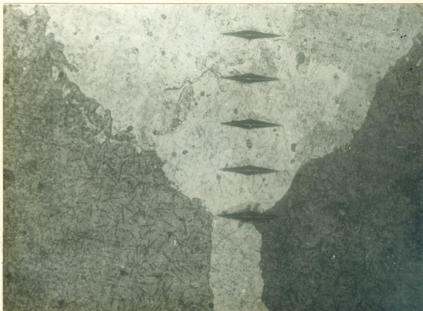
FIG. 17 - Fotomicrografia mostrando marcas de dureza Knoop após tratamento termo-endurecedor - 100 X
