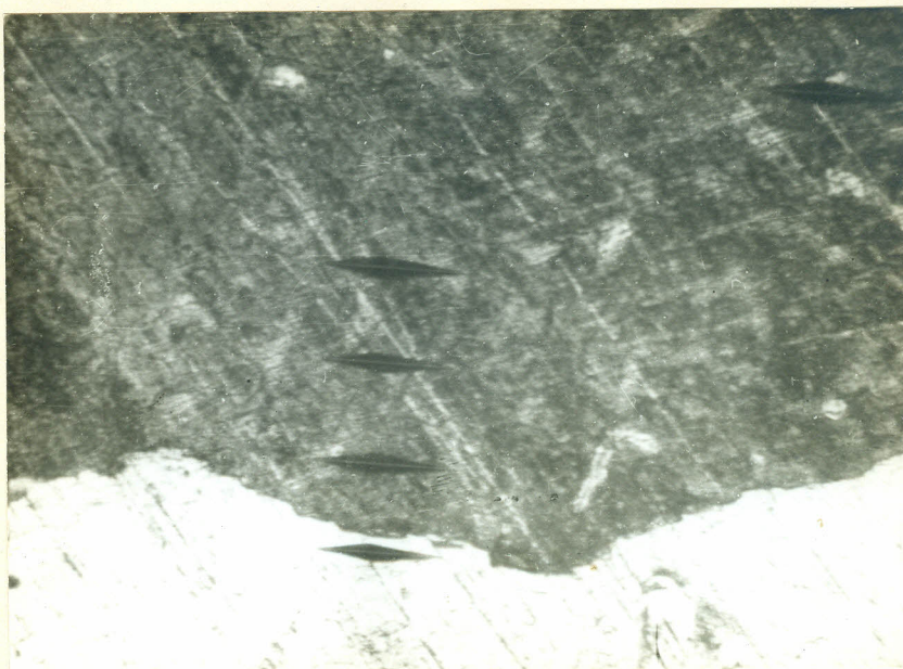
FIG. 7 - Fotomicrografia mostrando marcas de dureza Knoop, em "Bruto-de-Fusão" - 100 X
