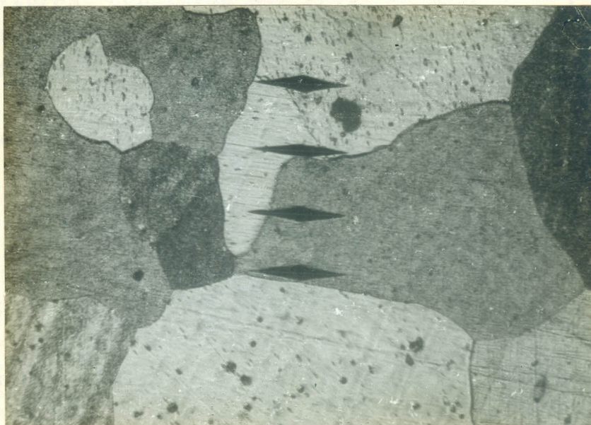
FIG. 13 - Fotomicrografia mostrando marcas de dureza Knoop após tratamento termo-anaciador - 100 X
