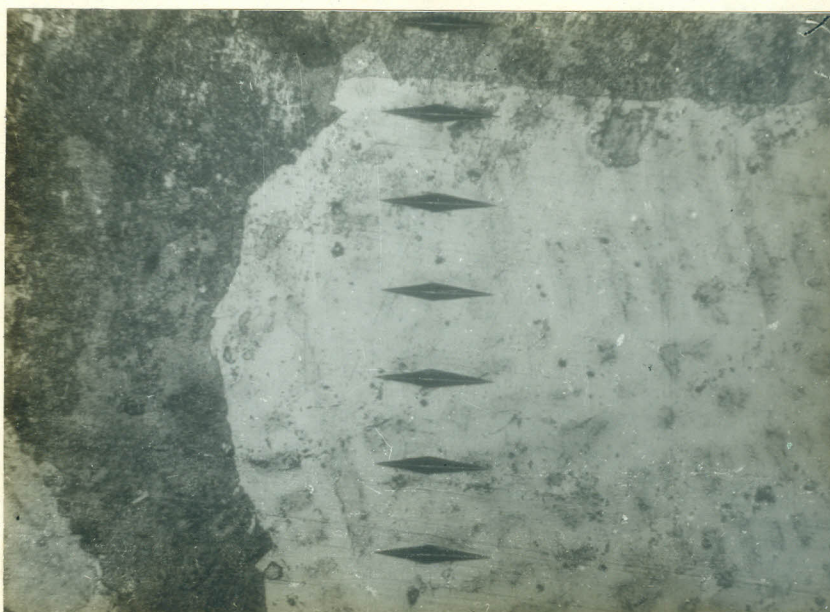
FIG. 15 - Fotomicrografia mostrando marcas de dureza Knoop após tratamento termo-endurecedor - 100 X
