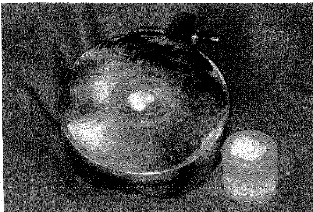
Figura 2 - Guia metálico contendo a amostra para o procedimento de desgaste.
