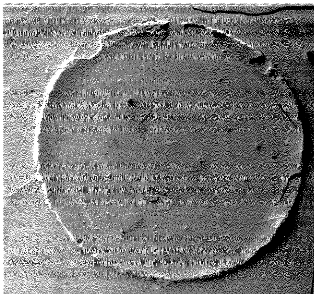
FIGURA 15 - Aspecto morfológico (16x) da superfície da dentina após o teste de resistência ao cisalhamento com o uso do sistema de união Etch&Prime 3.0. Nota-se falha adesiva com o adesivo cobrindo a dentina (A) e a dentina aparentemente livre de adesivo (F)
