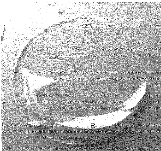
FIGURA 9 - Aspecto morfológico (16x) da superfície da dentina após o teste de resistência ao cisalhamento com o uso do sistema de união Single Bond. Nota-se o adesivo cobrindo a dentina (A) e restos de compósito (B), caracterizando falha mista.
