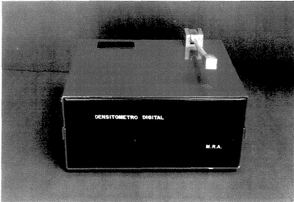
FIGURA 15 - Fotodensitômetro
