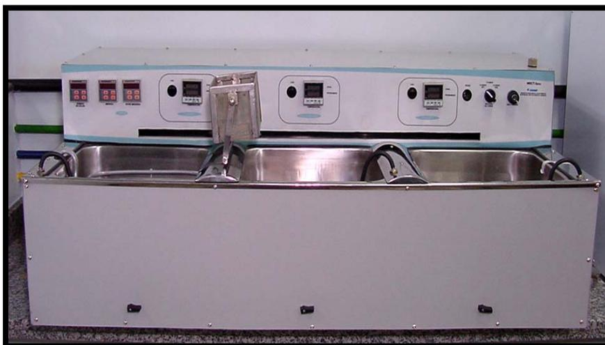
Figura 9: Máquina de ciclagem térmica MSCT – 3 Plus.
