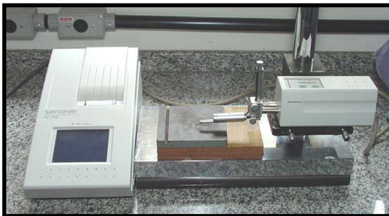
Figura 5: Rugosímetro SurfCorder SE 1700
