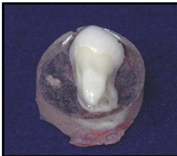
Figura 1: Dente parcialmente embutido em resina de poliestireno, com a face vestibular exposta.
