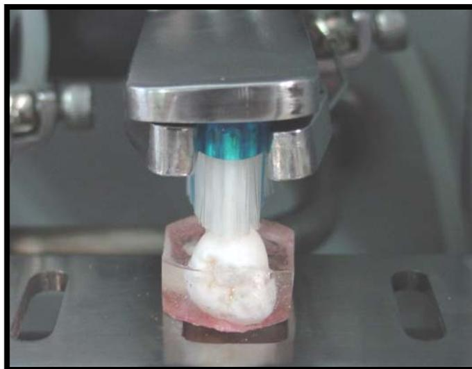
Figura 8: Corpo-de-prova e escova dental posicionados na máquina de escovação.
