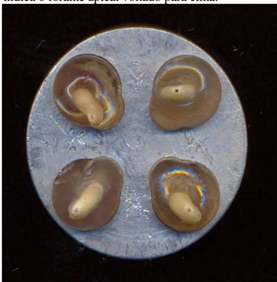
Figura 5 – Porta-espécimes múltiplo com quatro dentes posicionados em suas células, guiados pela cinta posicionadora, com os forames apicais voltados para o canhão de elétrons do MEV.
