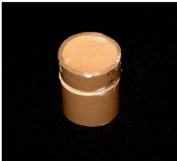
Fig 4 – Prenchimento da matriz em P.V.C. para formação da base do troquel.
