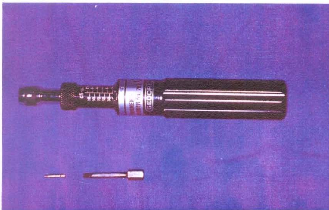
Fig. 9 Torquímetro tipo "chave de fenda", com conectores para adaptação do torquímetro ao implante.
