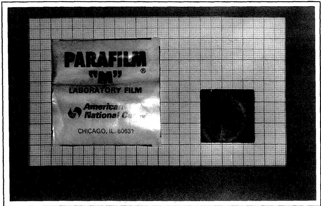
**Figura 9** – Materiais padronizados, utilizados para a análise mastigatória: a) parafilm "M" (lâmina de parafina com 5 cm<sup>2</sup>) e b) cenoura (cortada em quadrados de 2,5cm<sup>2</sup>/3mm).
