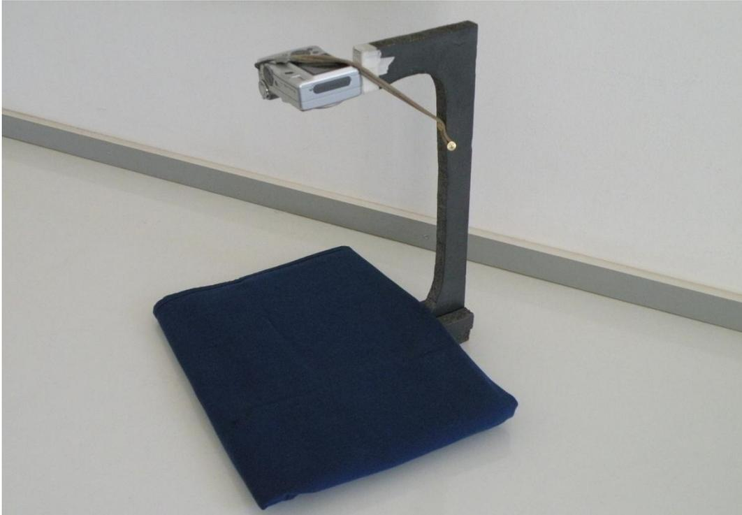
Figura 1 - Dispositivo padronizador fixador de câmera fotográfica digital utilizado neste estudo. A câmera fica a 27 cm da base, onde é colocada a mão do indivíduo.
