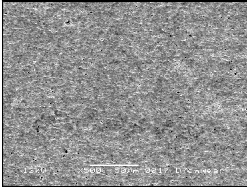
FIGURA 27 - Fotomicrografia ilustrando região de superfície de Dyract AP que não sofreu desgaste.
