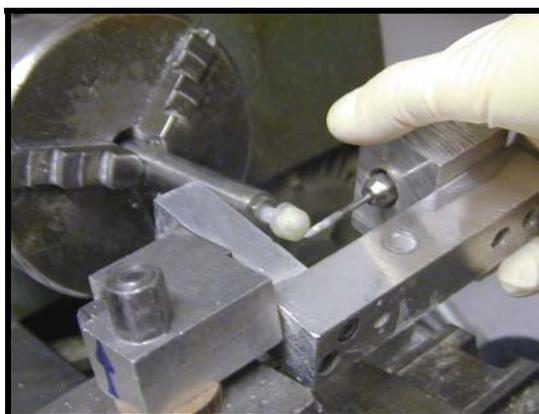
FIGURA 4 – Procedimento de torneamento da cúspide.
