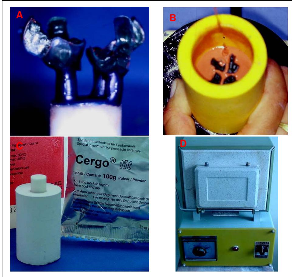
Figura 6. A. Padrão em cera fixado através de conduto de alimentação a base formadora; B. Anel de silicone sendo preenchido com revestimento refratário; C. Anel de revestimento cristalizado; D. Forno convencional para fundição.
