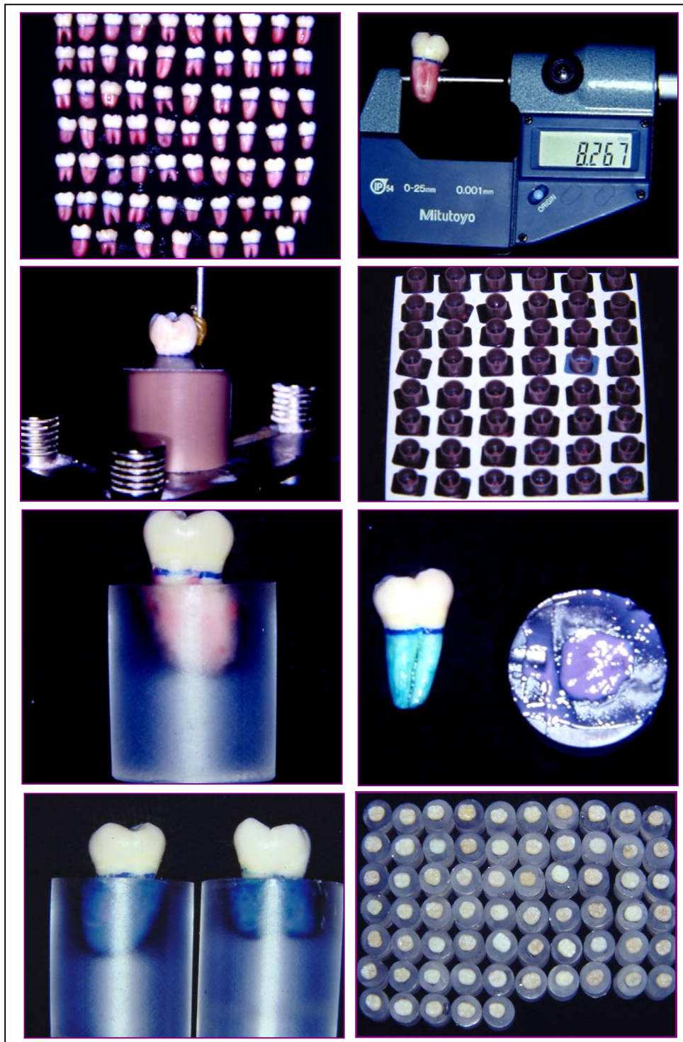
Figura 2. Processo de Inclusão do dente e simulação do ligamento periodontal.
