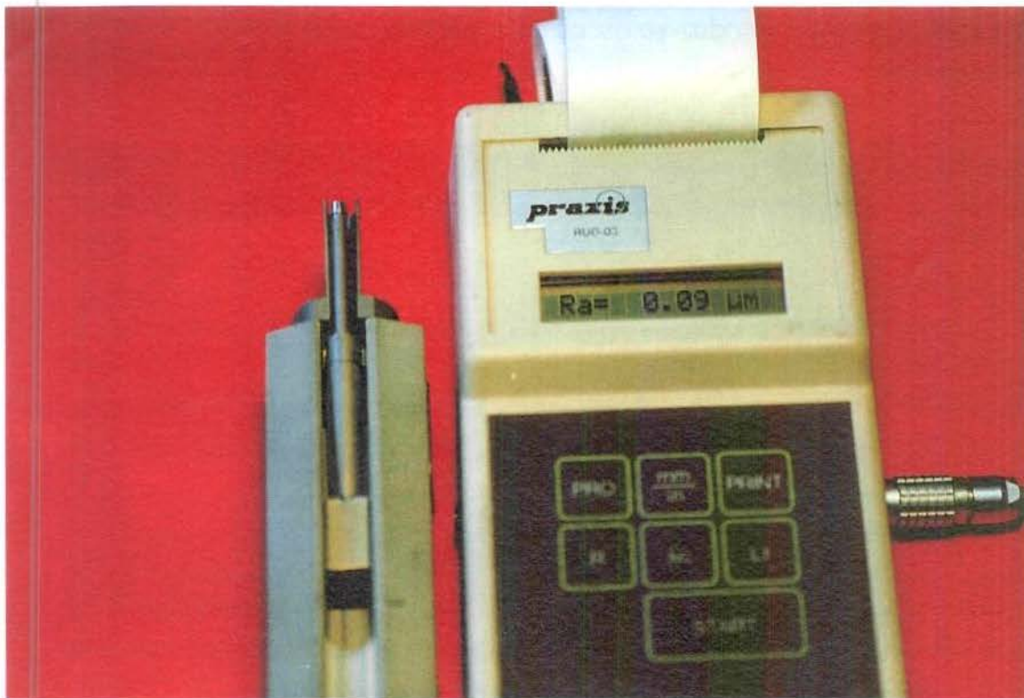
Figura 4.2.7 - Rugosímetro utilizado para determinar a rugosidade superficial dos fios ortodônticos.
