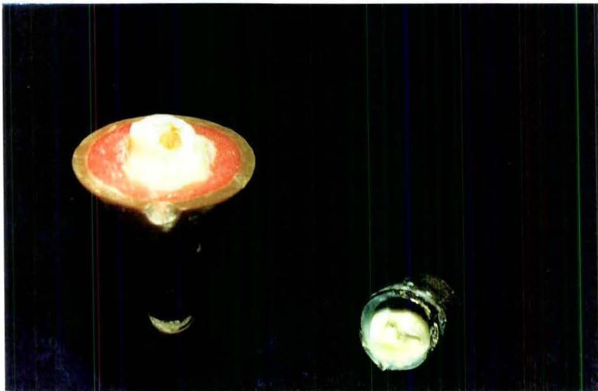
FIGURA 5.7 – Corpo-de-prova apresentando falha coesiva em dentina.
