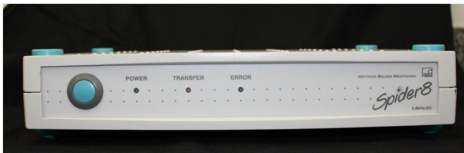
Figura 5 - Tensiômetro Spider 8 (HBM do Brasil)
