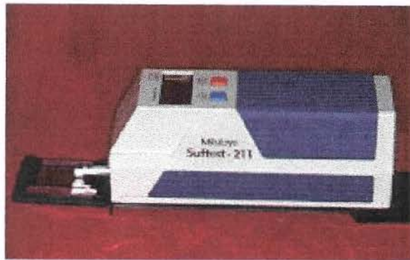
Figura 4.4: Rugosímetro – Mitutoyo Surftest 211
