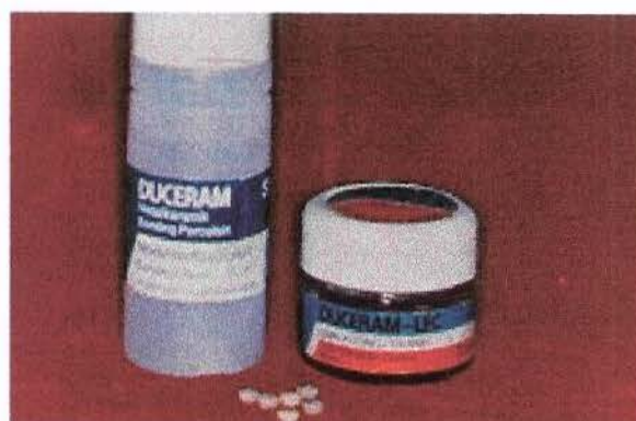
Figura 4.2: Cerâmica Duceram – LFC, pó/líquido e corpos de prova.
