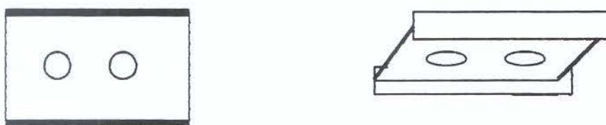
**Figura 2:** Projeto da moldeira individual de alumínio, com dimensões aproximadas de: 15 x 25 mm de largura e comprimento, respectivamente. Espessura de 1mm, no corpo e 6 mm nas bordas laterais. Orifícios com diâmetro de 4 mm.
