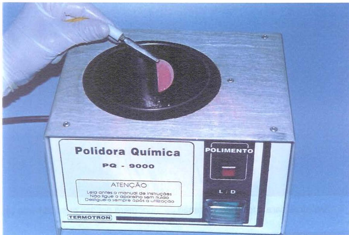
Fig. 3 - Polimento químico de uma amostra para o teste de liberação de monômero.
