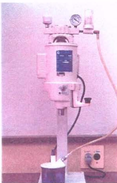
Figura 3: Espatulador mecânico a vácuo.
