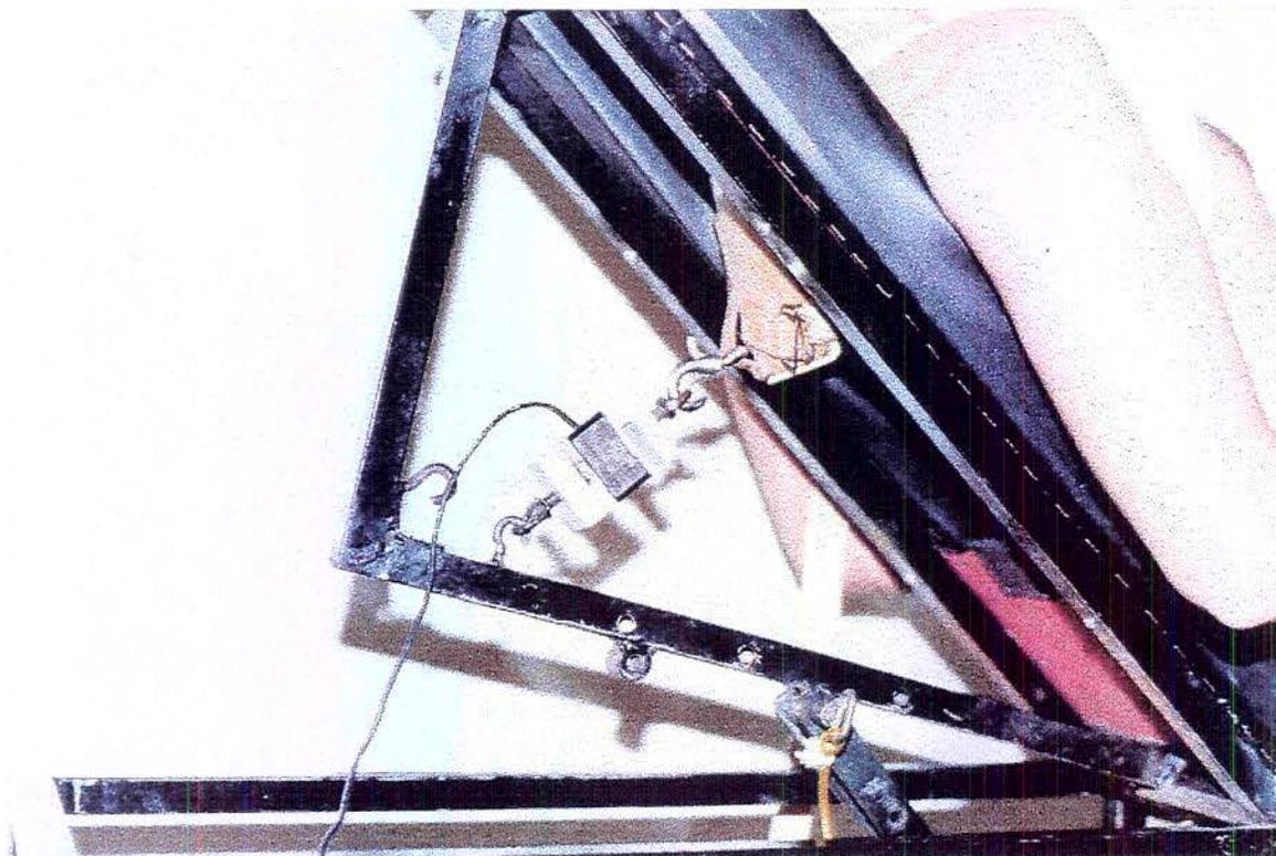
**Figura 7** – Célula de carga (CC) modelo MM, da Kratos<sup>3</sup>, fixada nos ganchos do encosto do banco e da cinta inter-escapular.
