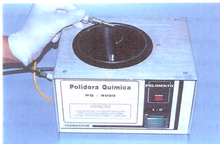
Figura 4: Amostra para avaliação de monômero sendo polida quimicamente.
