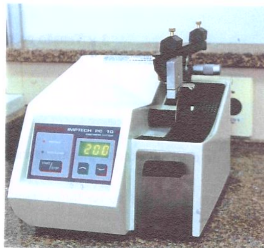
Figura 9: Amostras do ensaio de dureza sendo cortados pela cortadeira IMPTECH PC 10
