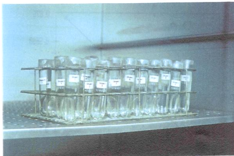
Figura 7: Corpos da avaliação de monômero liberado na água acondicionados na estufa
