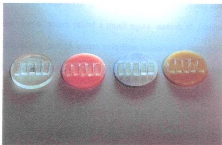
Figura 10: Amostras do ensaio de dureza interna com a face interna exposta
