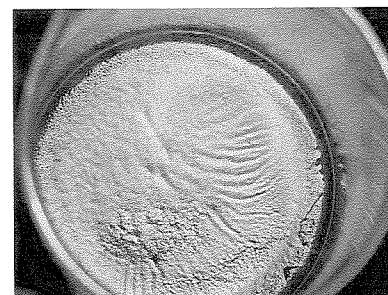
Fig.7- Cera ou resina após evaporação
