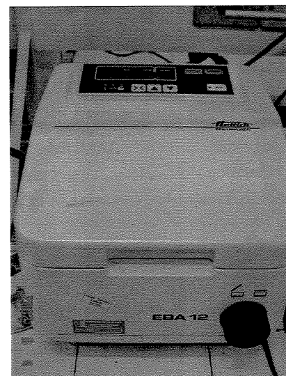
Fig. 3- Centrífuga para sedimentação da parte inorgânica.
