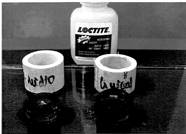
Fig. 33- Tubos de PVC para inclusão das amostras. Base com placa de vidro e vedamento com cianoacrilato.
