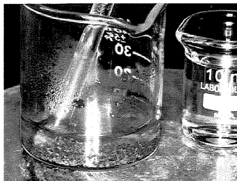
Fig. 8- Lavagem em HCl a 2,4M.
