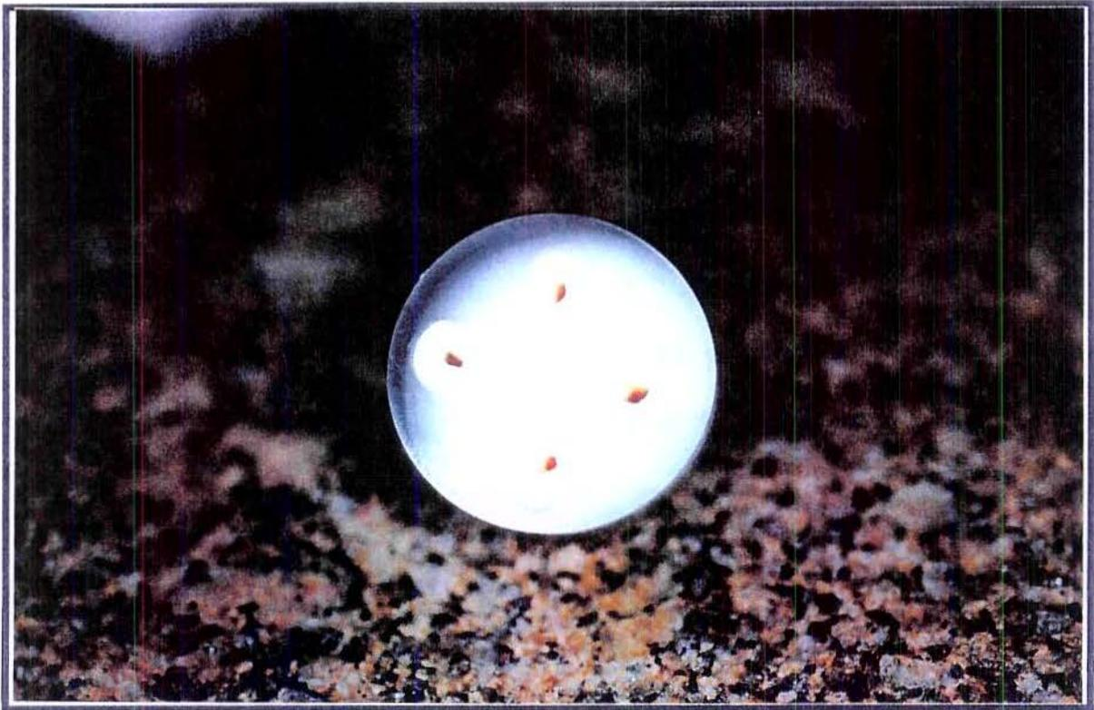
Figura 5 - Bloco de acrílico polimerizado contendo 4 corpos de prova
