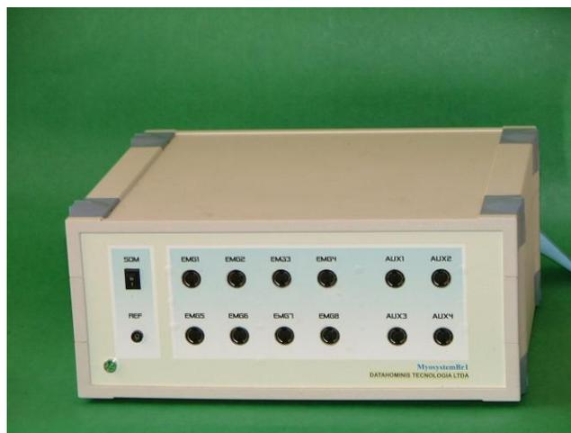
**Figura 2**– Eletromiógrafo Myosystem-BR1 (Datahominis Tecnologia Ltda).
