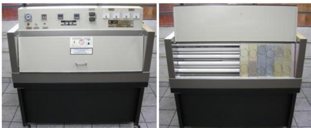
**Figura 10** - Sistema de envelhecimento artificial acelerado para não-metálicos C-UV.
