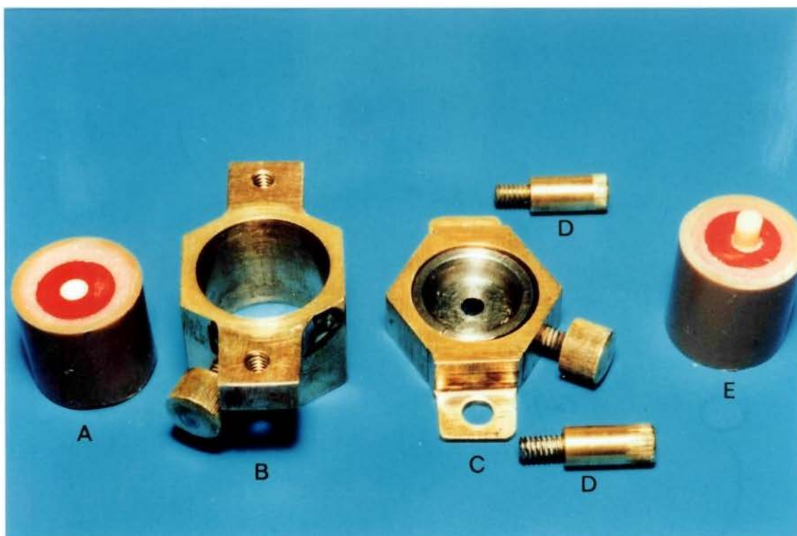
Figura 5 - Disposição seqüencial da amostra e matrizes utilizadas para confecção do corpo-de-prova. A, amostra; B, matriz usada para posicionar a amostra; C, suporte metálico com a matriz de aço inoxidável no seu interior; D, parafusos de fixação; E, corpo-de-prova.
