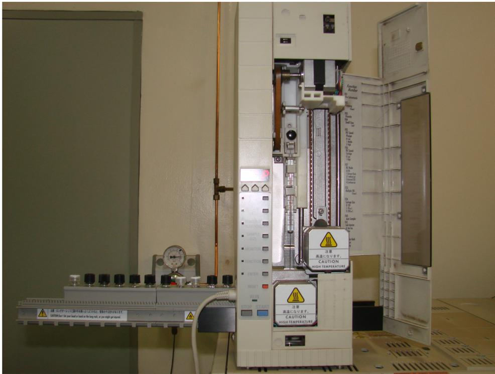
**Figura 7 -** Detalhe do injetor automático
