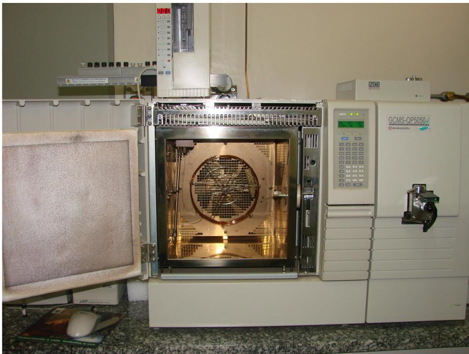
**Figura 8 -** Interior do cromatógrafo em fase gasosa. Foto do forno de aquecimento e da coluna cromatográfica
