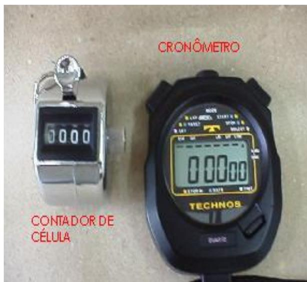
**Figura 5** - Contador de célula e cronômetro – utilizados para quantificar as respostas comportamentais.
