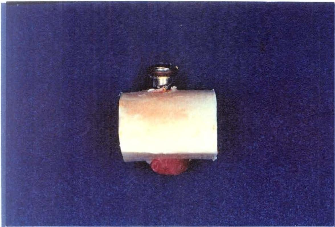
**Figura 10.** Proteção da ponta do parafuso de cada amostra com cera utilidade.
