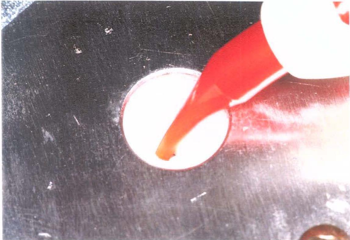
Figura 2. Inserção do compósito com auxílio de seringa Centrix na região central da matriz de teflon e exatamente na área dentinária demarcada pela fita adesiva.
