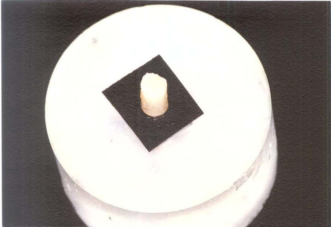
Figura 4. Corpo de prova preparado, após remoção do dispositivo, mostrando a região demarcada da fita adesiva preenchida por cilindro de compósito.
