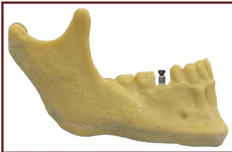
Figura. 6- Hemimandíbula em poliuretano com o implante posicionado e fixado na região do segundo pré-molar.
