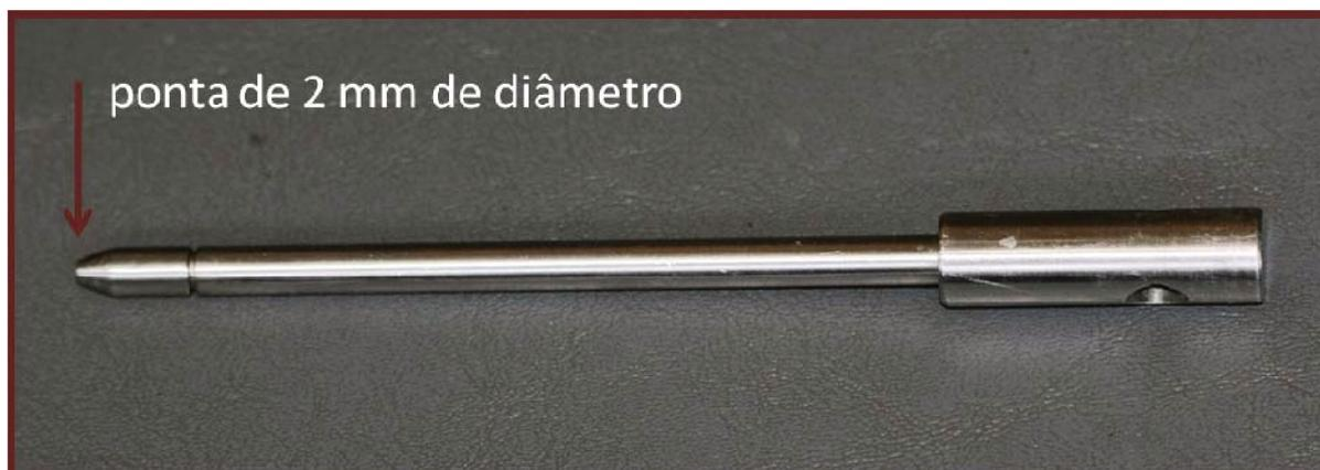
Figura. 14- Pino com ponta de 2 mm de diâmetro incidia sobre os conectores protéticos dos diferentes implantes.
