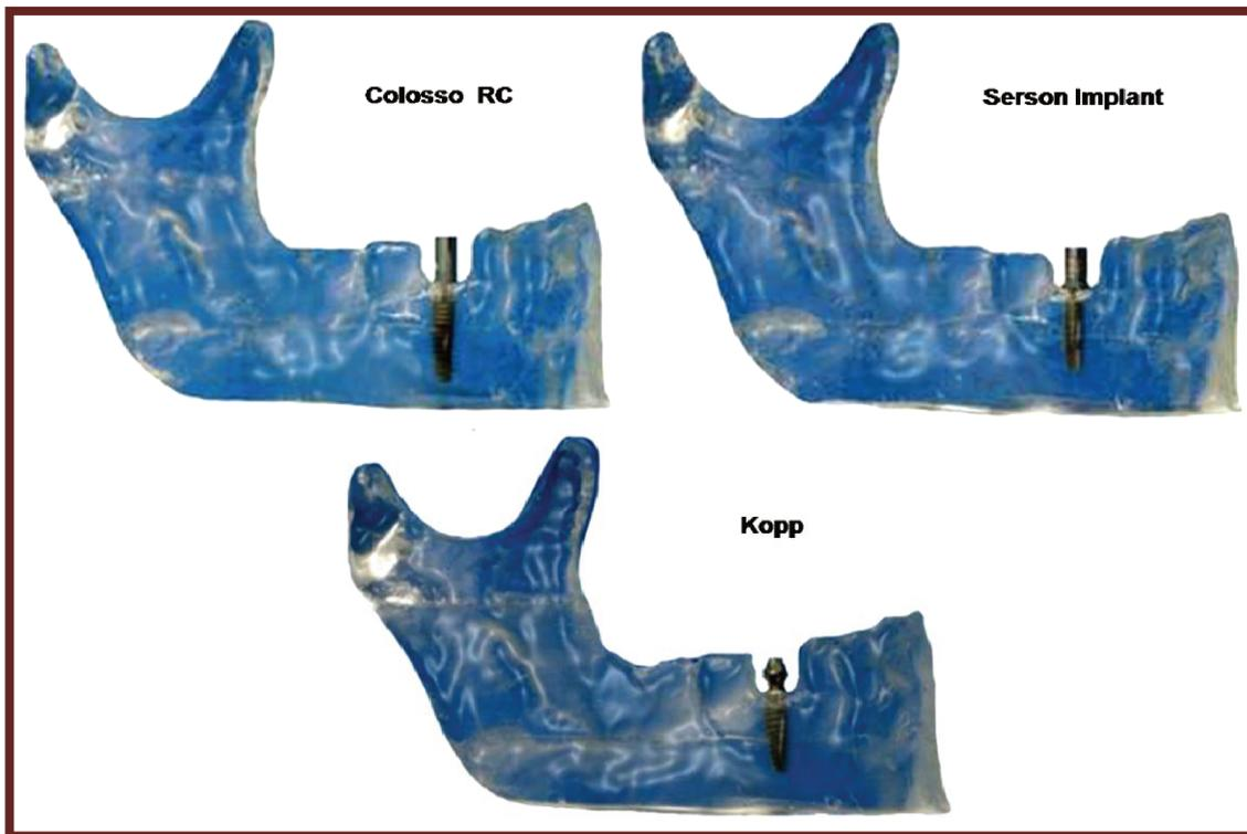
Figura.12 - Confeção de hemimandibulas em resina fotoelástica,contendo em seu interior os implantes utilizados na metodologia.
