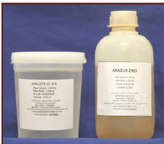
Figura.11a - Araldite GY 279 e Aradur 2963, resinas utilizadas para a confecção dos modelos fotoelásticos.
