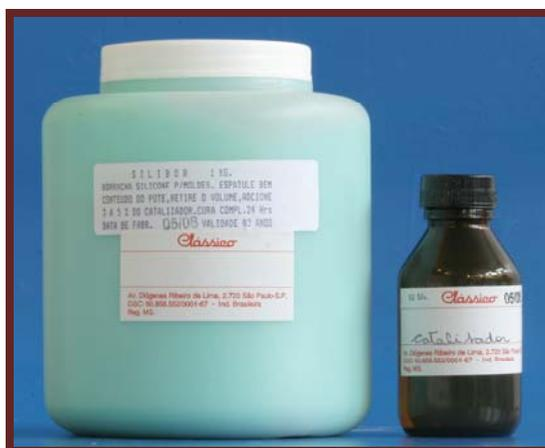
Figura 9 – Material a base de silicone para moldagem
