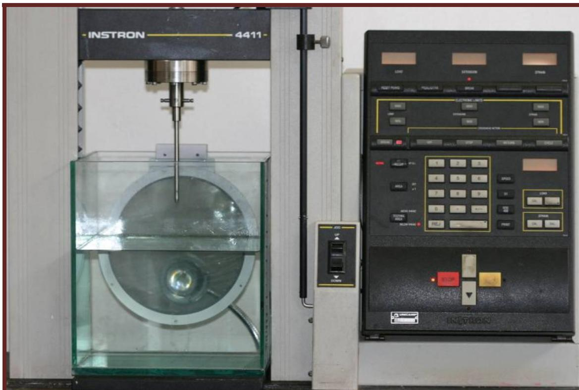
Figura. 5- Vista frontal do polariscópio acoplado à máquina de ensaio Universal Instron, modelo 4411
