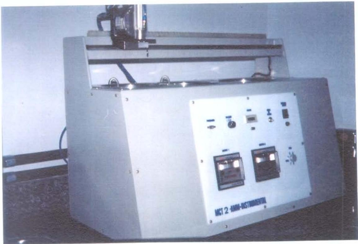
Figura 5- Máquina de termociclagem na qual os corpos de prova receberam 1000 ciclos, com temperaturas de  $5\pm 1^{\circ}\text{C}$  e  $55\pm 1^{\circ}\text{C}$ .
