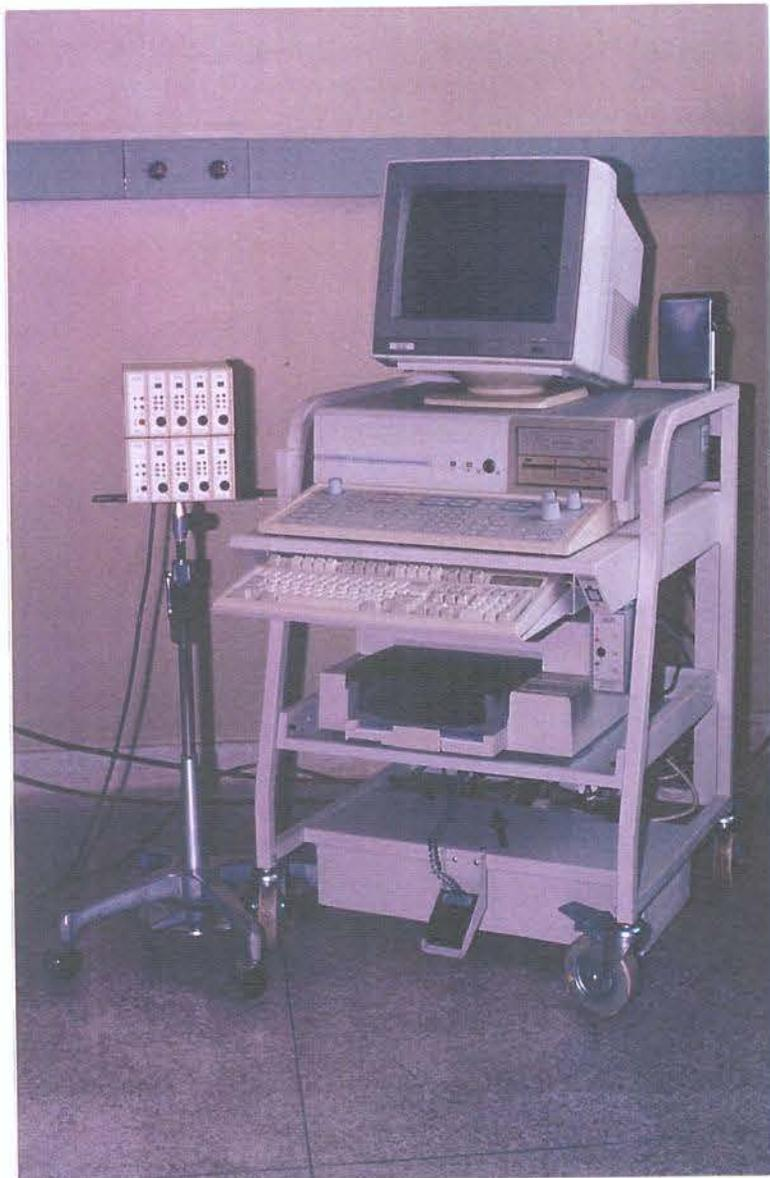
**Fig. 1 - Eletromiógrafo Nicolet-Vicking II da Nicolet Biomedical Instruments de 8 canais, com sistema automático de aquisição do sinal eletromiográfico, com impressora HP Desk-Jet.**
