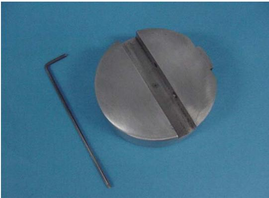
**Figura 8:** Dispositivo em aço para o acabamento dos blocos de resina acrílica.
