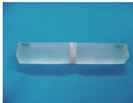
**Figura 14:** Amostra polimerizada por luz visível.
