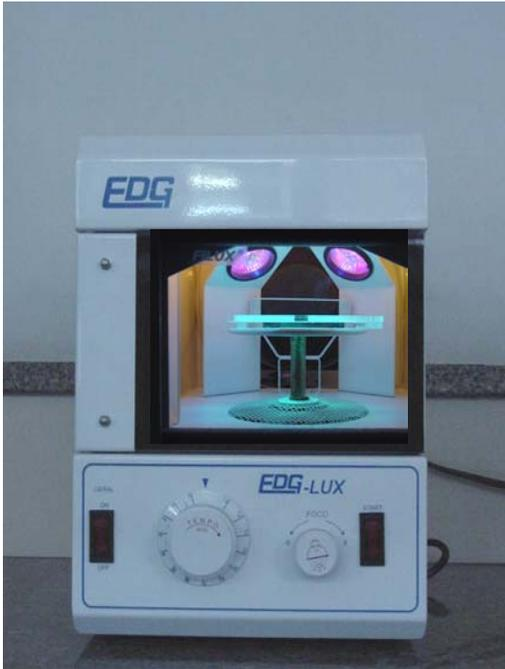
**Figura 5:** Fotopolimerizador EDG-Lux.
