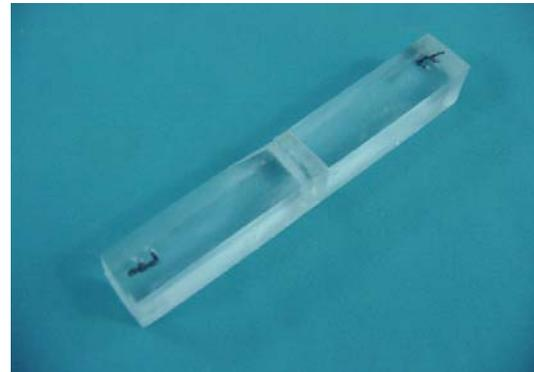
**Figura 12:** Amostra polimerizada por energia de microondas.
