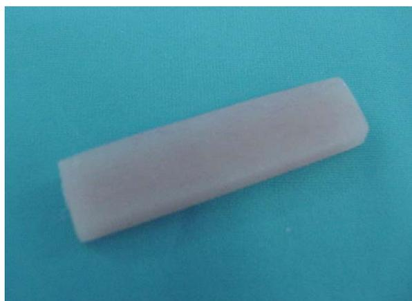
**Figura 19:** Amostra polimerizada por luz visível.
