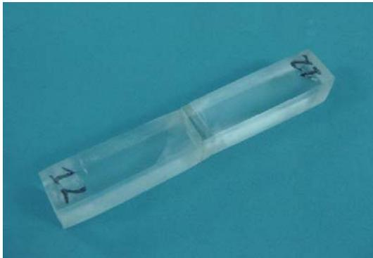
**Figura 11:** Amostra polimerizada pelo método de banho de água quente.
