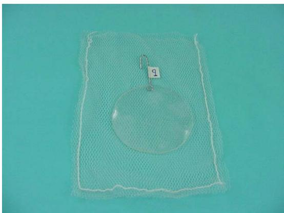
**Figura 20:** Amostra colocada dentro do invólucro de filô.
