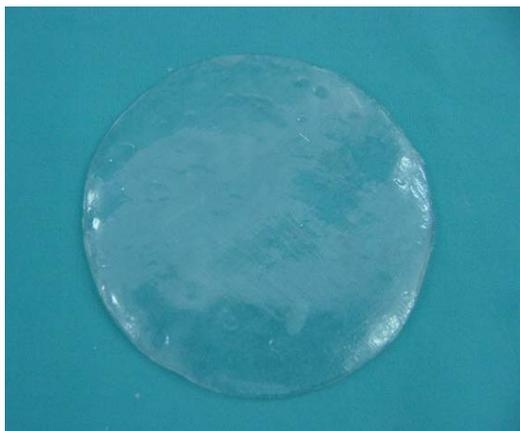
**Figura 3:** Amostra polimerizada pelo método de banho de água quente.
