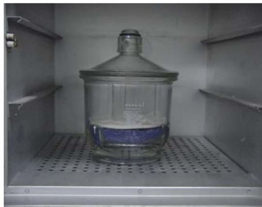
**Figura 21:** Estufa para desidratação e armazenagem das amostras.
