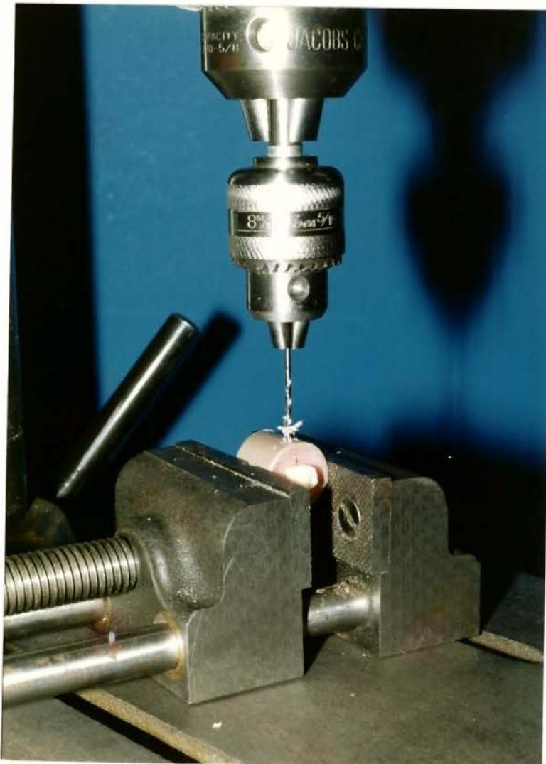
Figura 5 - Perfuração do corpo de prova
