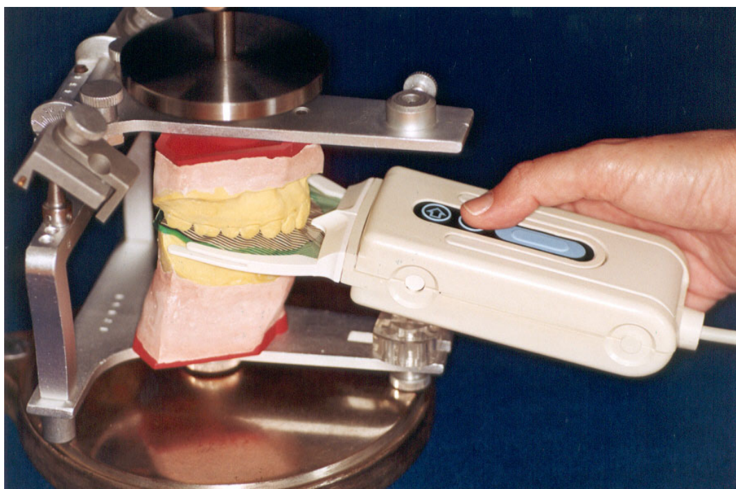
Figura 9 - Articulador posicionado na plataforma inferior do dispositivo, recebendo carga com o sensor interposto nos modelos e o operador registrando os contatos oclusais.
