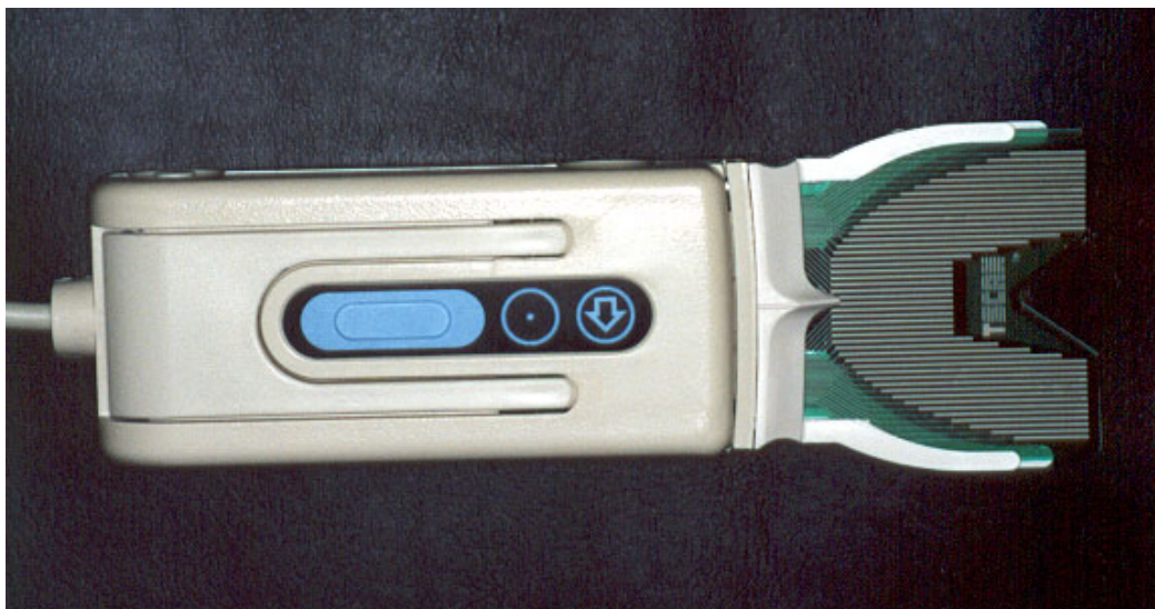
Figura 3 – Vista superior do dispositivo de manuseio com o sensor instalado no garfo. A direita trava para conectar e desconectar o sensor e botões para controle operacional.
