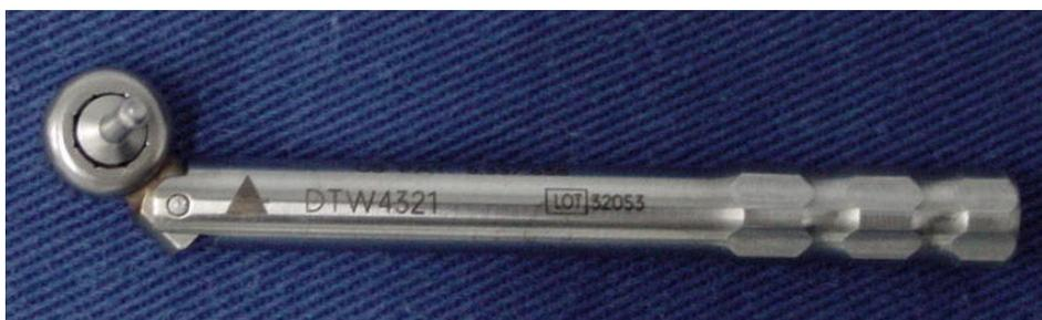
Figura 13 - Angulação assumida pelo torquímetro, quando o torque de 30 Ncm foi atingido.
