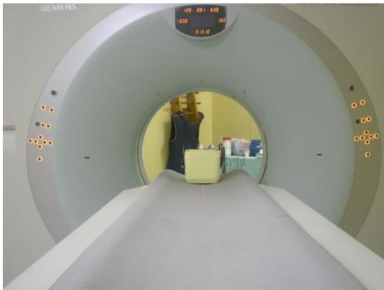
Figura 6 – Tomógrafo *Multislice* de 40 canais *SOMATON SENSATION*.
