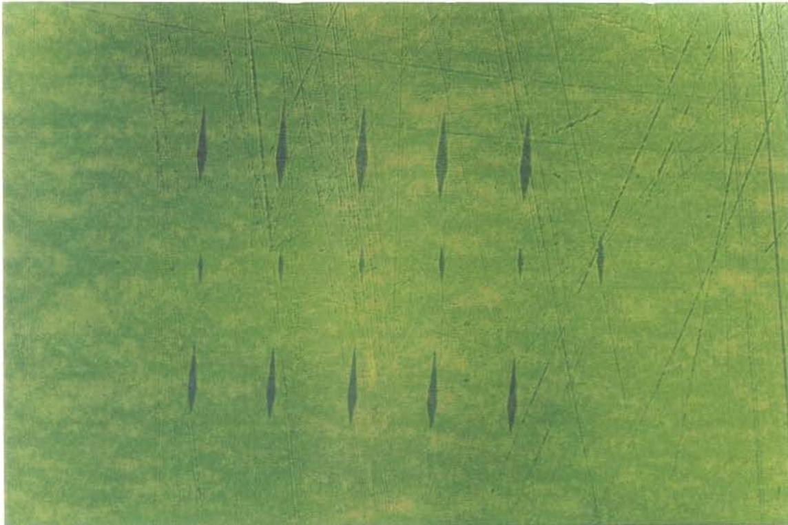
Figura 23 – Aspecto microscópico (50x) do esmalte dental do grupo glicose+frutose e as impressões realizadas. 1- Marca de referência (100 g); 2- Dureza inicial; 3 e 4- Dureza após o tratamento
