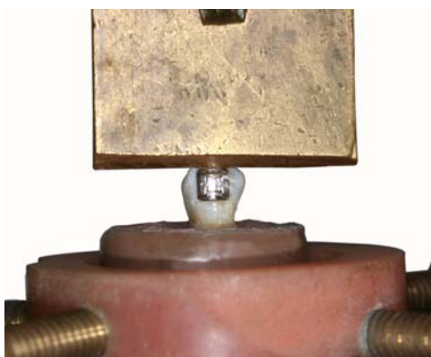
Figura 20: Ensaio de resistência ao cisalhamento com ponta ativa em cinzel apoiada na região da interface esmalte/compósito.
