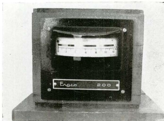
*Fig. 4 - Pirômetro - Portátil da ENGRO*
