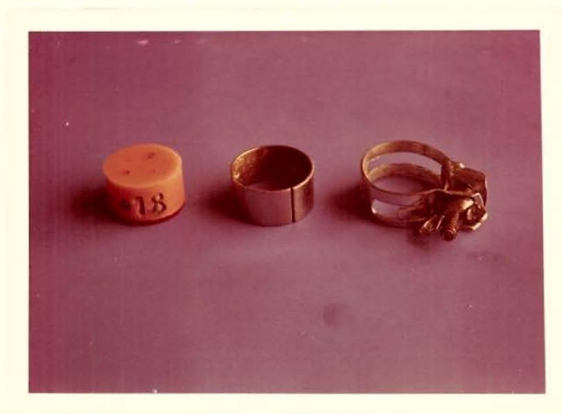
Fig. 3.3.2 - Matriz para inclusão dos corpos de prova
