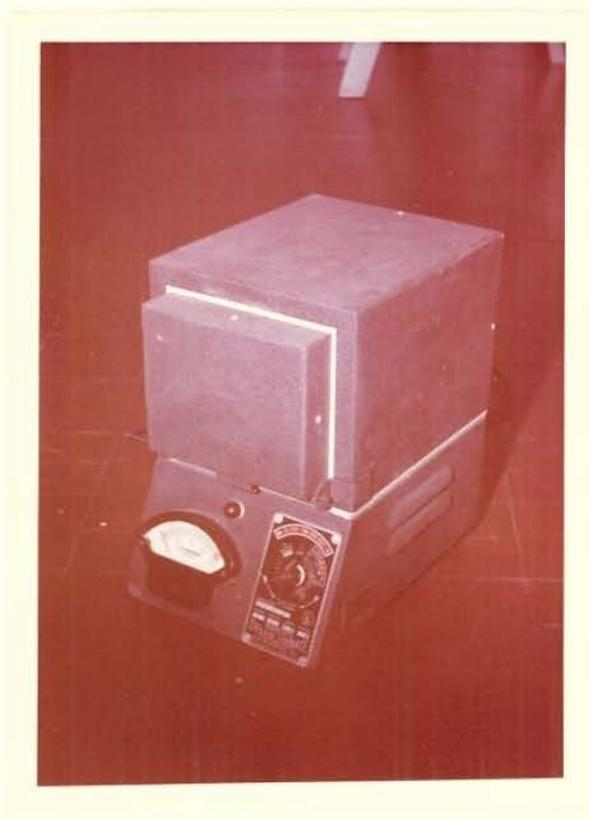
Fig. 3.3.1 - Forno "HUPPERT" utilizado para tratamento térmico
