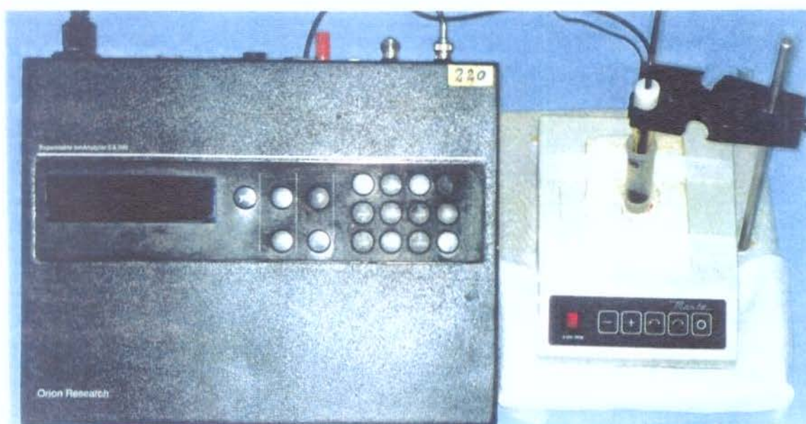
Fig.11- Eletrodo específico para flúor modelo ORION 96-09 acoplado ao analisador de íons mod. ORION EA-940 e agitador magnético MARTE.
