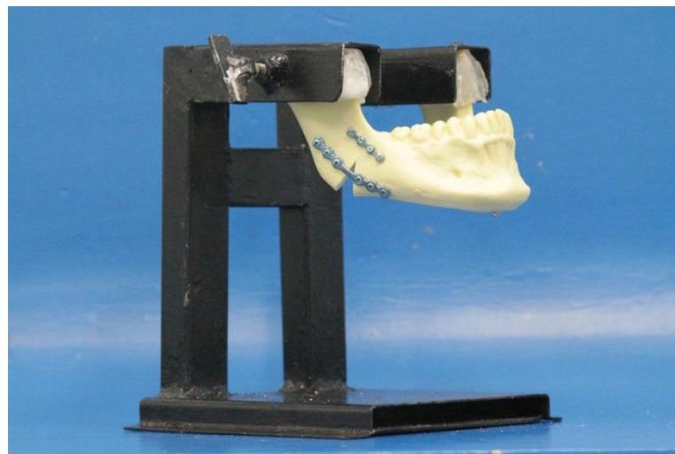
Figura 11 – Vista lateral da mandíbula de poliuretano fixada no suporte confeccionado para realização deste estudo.
