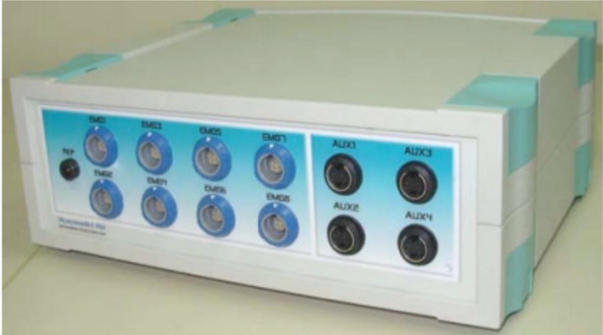
**Figura 1:** Eletromiógrafo MyosystemBr1 P84 / DataHominis Tecnologia Ltda.
