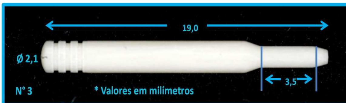
**Figura 2** – Dimensões do pino AESTHETI-PLUS n°3.
