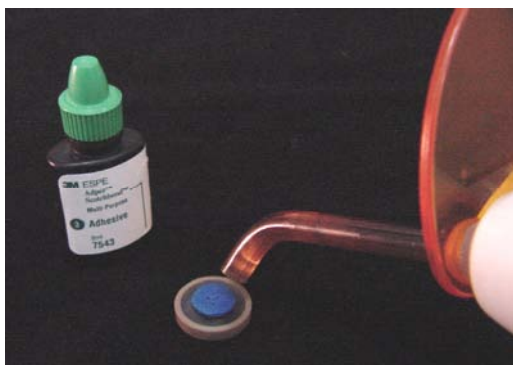
Figura 4 - Foto-ativação do adesivo sem carga através do molde de elastômero.
