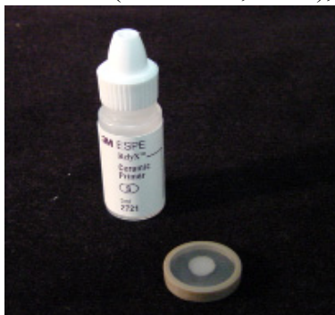
Figura 3 - Silano e disco cerâmico incluído em tubo de PVC com resina epoxy.
