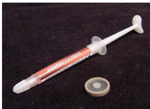
Figura 2 - Ácido fluorídrico a 10% e disco cerâmico incluído em tubo de PVC com resina epoxy.
