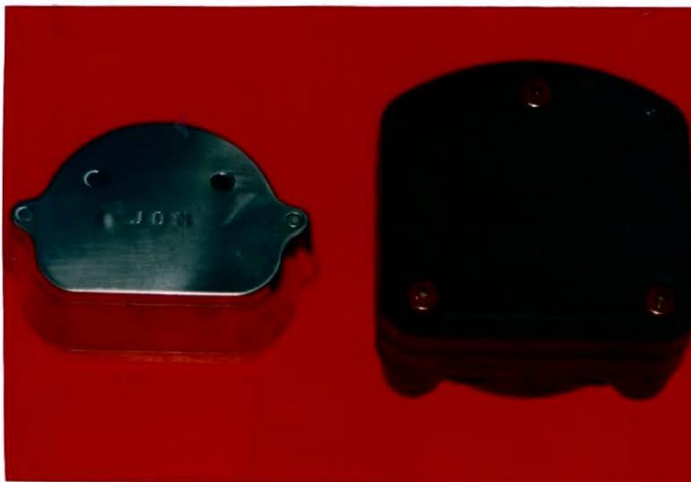
Figuras 6.3- Tipos de muflas. a- metálica; e, b- fibra de vidro reforçado
